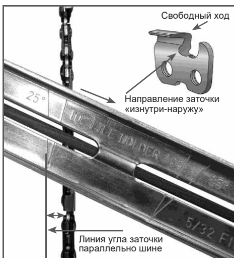
Рис. 22 Расположение линии угла заточки
