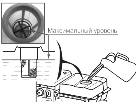
Рис. 8 Максимальный уровень топлива в топливном баке
