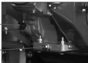
Рис. 10 Проверка уровня масла в картере
